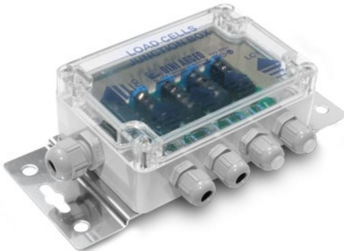
Scatola di giunzione IP67 a 4 ingressi specifica per ambienti esterni, permette di essere utilizzata come scatola di equalizzazione o di giunzione semplice di 2, 3 o 4 celle di carico. Morsettiere a vite per agevolare il collegamento e trimmer di regolazione del segnale, per una equalizzazione precisa ed affidabile. Il circuito di protezione protegge contro fulmini e sovratensioni.
