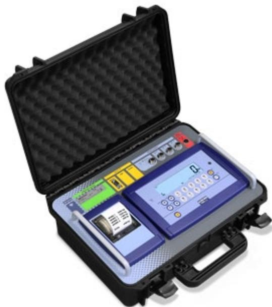
Indicatore di peso digitale multifunzione in versione Rack, completo di 4 connettori per collegamento piattaforme, batteria interna ricaricabile, caricabatteria, stampante termica, orologio calendario e valigia. Ideale per applicazioni di pesatura veicoli. Omologabile CE-M (OIML R-76 / EN 45501).
