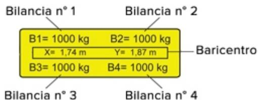
Adatto per la creazione di sistemi pesa ruote, pesa assi statici oppure per pesare oggetti a più punti d'appoggio. Particolarmente indicato per la pesatura e il calcolo delle coordinate di baricentro di automobili, camion, aerei, container etc. Visualizzazione contemporanea del peso di ogni piattaforma collegata e della somma. Omologabile CE-M (OIML R-76 / EN 45501).
