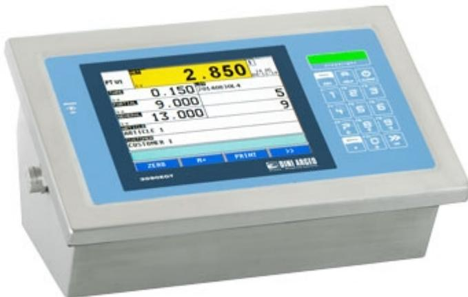
Indicatore di peso digitale con grande display touch screen, indicato per applicazioni industriali evolute. Permette la visualizzazione di tutti i dati legati alla pesata e la personalizzazione delle schermate, semplificando notevolmente le operazioni dell'utente. Dotato di 3 porte seriali, protocolli di trasmissione per comunicazione dati, stampe completamente configurabili, alibi memory integrata e ingresso per lettore di barcode/badge. Omologabile CE-M (OIML R-76 / EN 45501).
